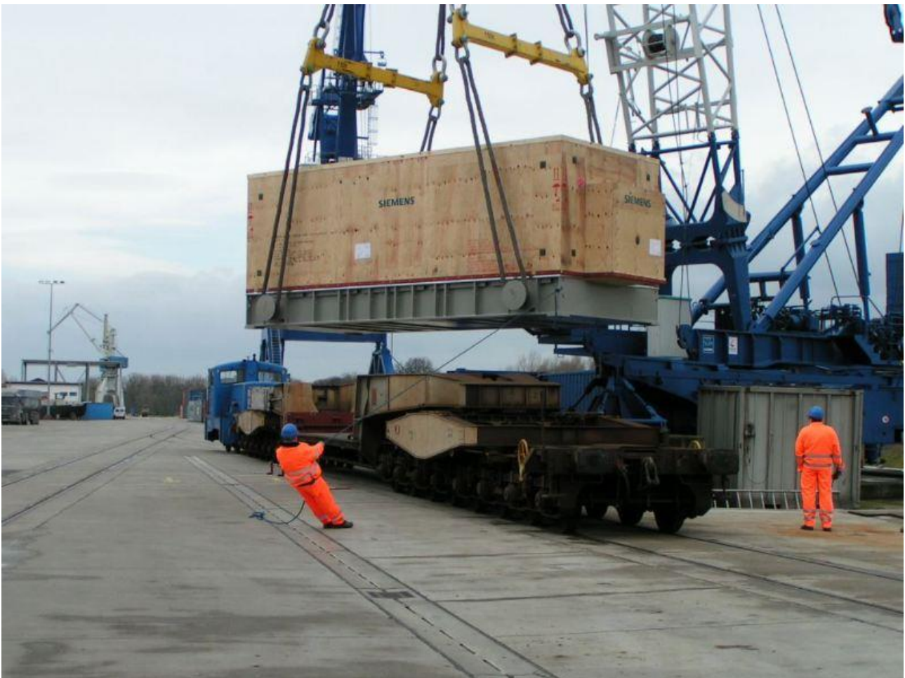
Verladung eines Schwergutcollies durch den stationären Schwerlastkran von der Schiene auf das Binnenschiff
