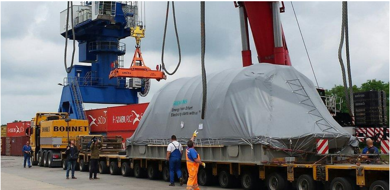
Verladung durch stationären Schwerlastkran und Mobilkran vom Straßenschwerlasttransport auf das Schiff
