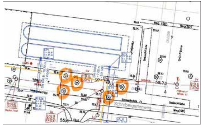
Abbildung 2: Notwendige Baumfällungen für das Aufstellen des 300t-Kranes - Geobasisdaten©GeoBasis-De/LVermGeo LSA, 2022 /A18-1903-2011-7
