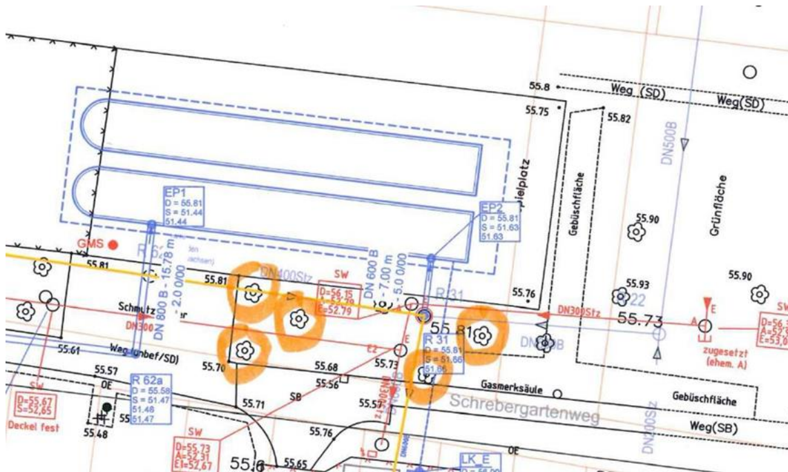
Abbildung 2: Notwendige Baumfällungen für das Aufstellen des 300t- Kranes
