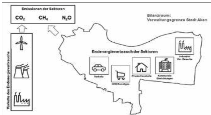
Prinzipskizze zur Bilanzierungs-Systematik Kommunal (BISKO-Standard) der Energie- und Treibhausgas-Bilanz der Stadt Aken (Elbe), Quelle: IKSK Aken (04-2025)
